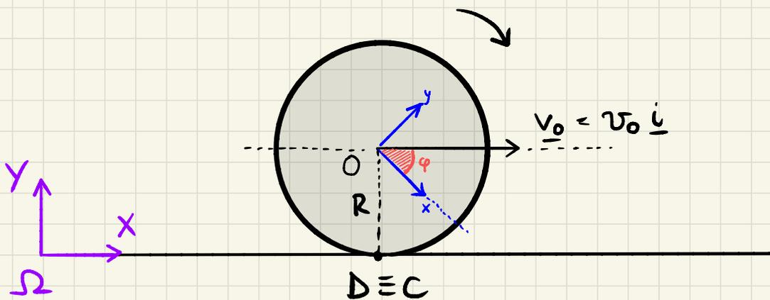
Soluzione Siano  $\underline{i}, \underline{j}, \underline{k}$  versori associati agli assi fissi  $X, Y, Z$  (quest'ultimo uscente dal piano del foglio). Sia  $v_0 = |\underline{v}_0|$  e  $\varphi$  l'angolo tra l'orizzontale e un asse  $x$  solidale al disco. Allora abbiamo che
