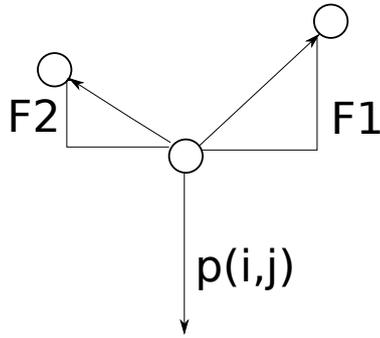
Figura 1: Le componenti verticali delle due forze di tensione  $F1$  e  $F2$  sono proporzionali alla differenza di altezza tra i due punti
